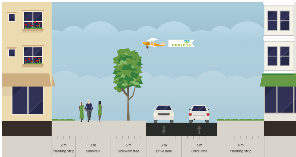
Kuva: Tapionranta-kadun poikkileikkaus. Sitowise 2021
