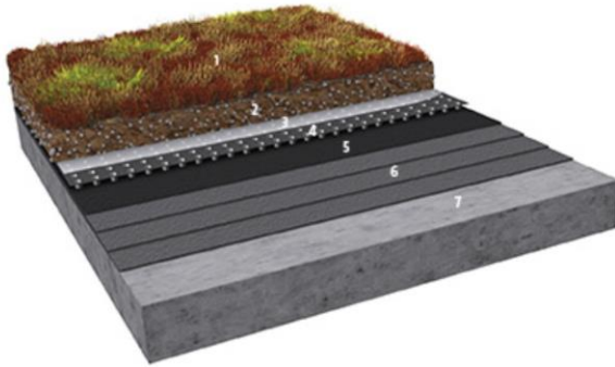
Kuva 9. Viherkaton rakenteet. Kuva: Leca Finland Oy.
