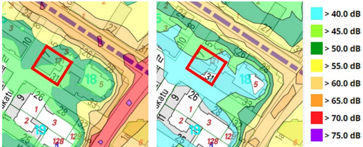
Kuvat 10 ja 11. Yhteismelu suunnittelualueella. Kuvassa 10 on esitetty päiväajan melu ja kuvassa 11 yöajan melu. Kuva: WSP Finland, 2022.
