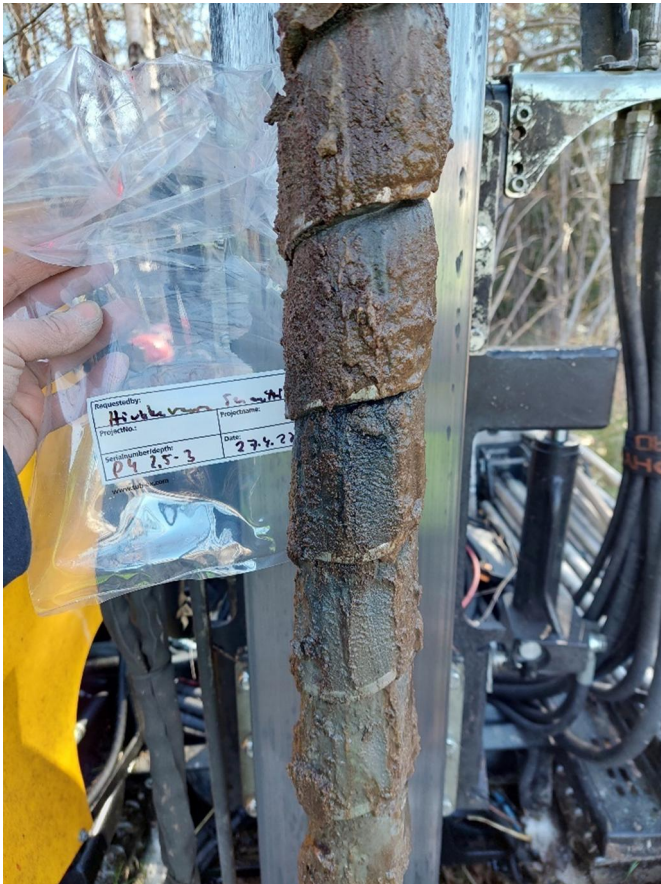
Kuva 4. Alueen luonnonmaa on harmaa siltti. Kuvassa näyte P4 2,5-3 metrin syvyydeltä maanpinnasta. (27.4.2022)
