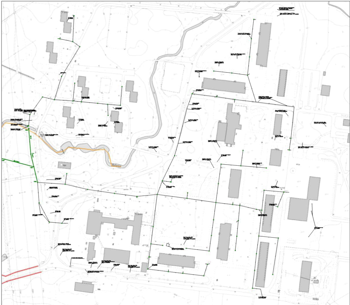
Kuva 10 Ote Oulun kaupungin webmap-palvelusta, Vanhan Hiukkavaaran nykyiset hulevesiviemärit (musta) kantakartalla. Vihreät putket ovat yleisen alueen hulevesiviemärointiä.
