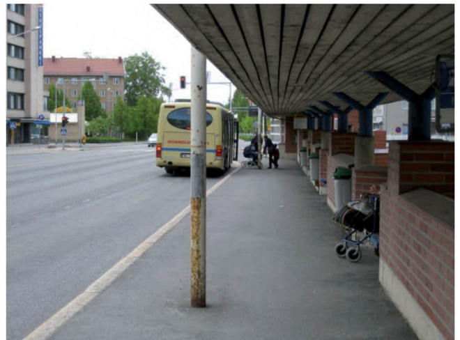
Kuvat 26 ja 27. Odotustilaa ei ole erotettu esim. laatoituksella Valtatiellä Itä-Tuirassa (ylempi kuva). Valaisinpylväät ja alhaalla oleva pysäkkitaulu aiheuttavat törmäysvaaran Merikoskenkadulla (alempi kuva).
