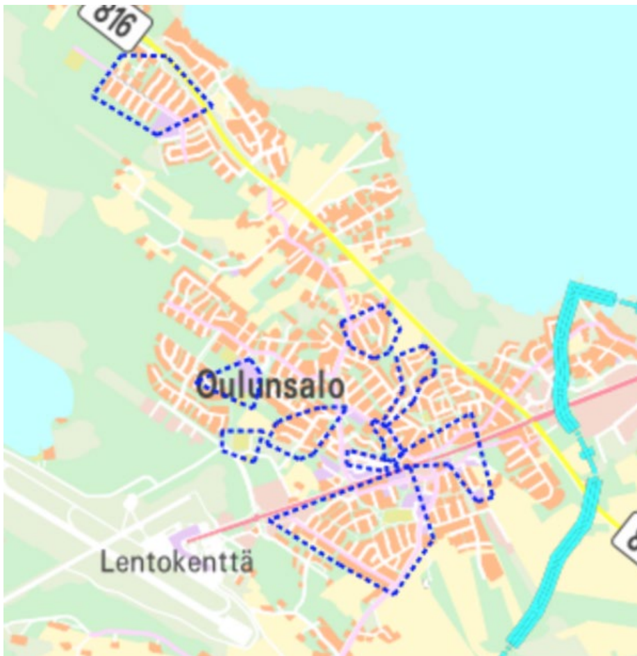
Kuva 44. Alueet, joilla on vanhempia hulevesiputkia (rakennettu ennen 2010).
