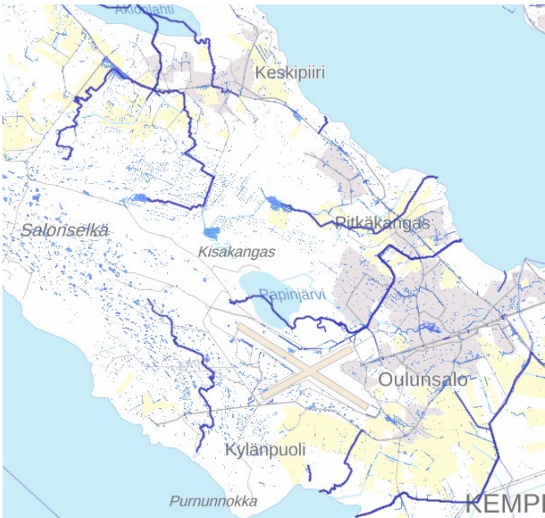
Kuva 22. Arvioidut tulva-alueet 1/20 vuoden toistuvuudella (kuva: Scalgo Live 2022).
