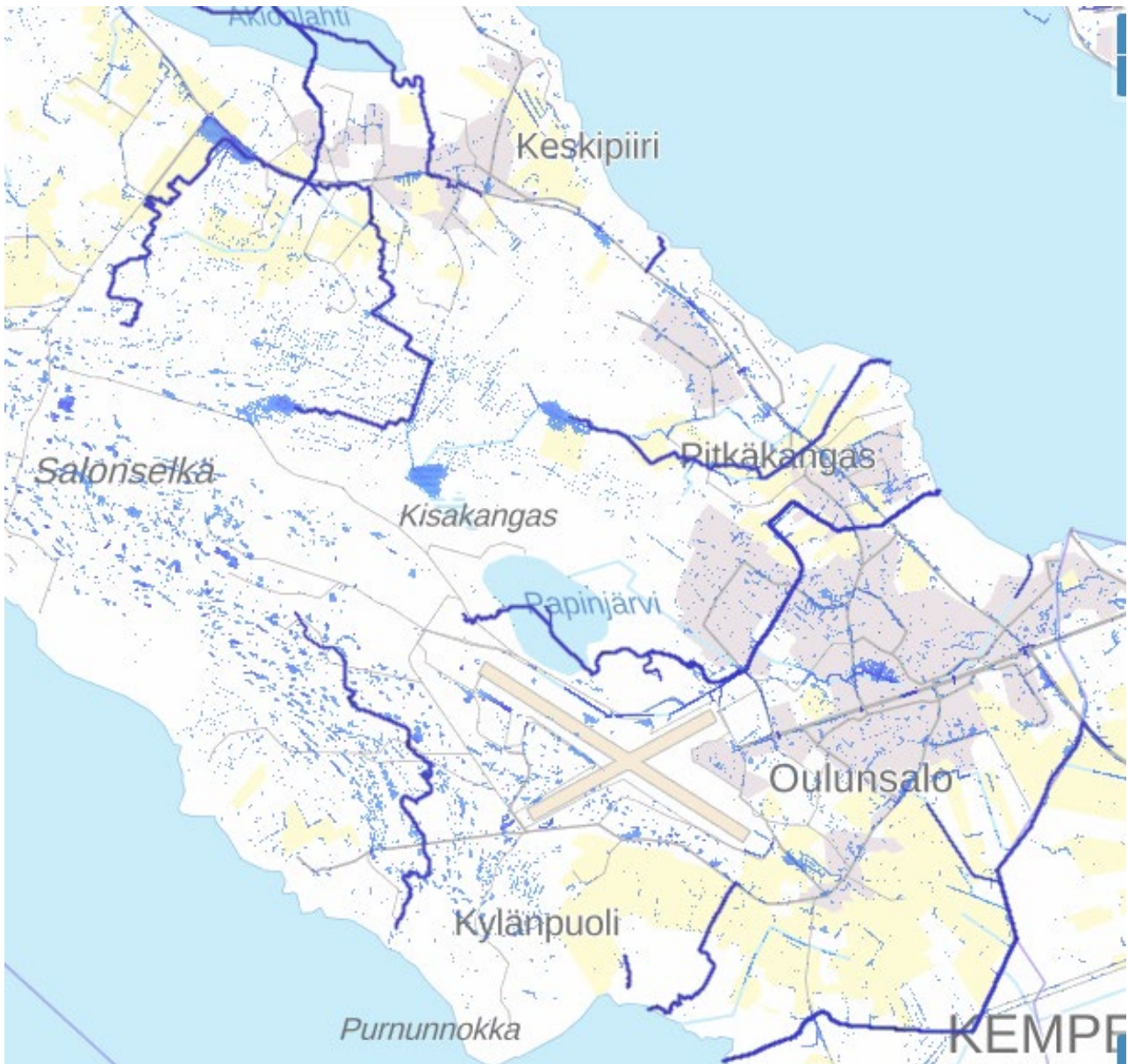
Kuva 23. Tulva-alueet 1/100 vuoden toistuvuudella (kuva: Scalgo Live 2022).
