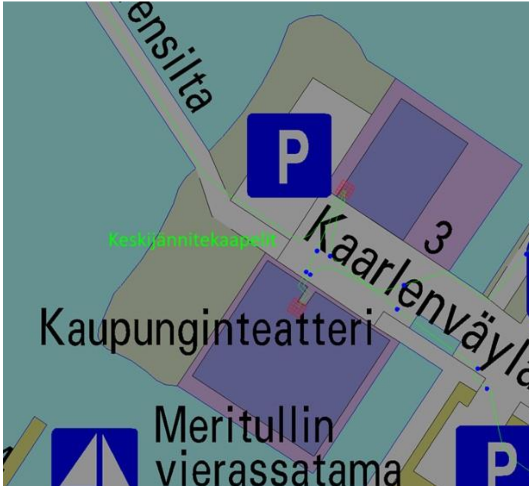
Kuva 74. Nykyinen keskijänniteverkko. Kuva: Oulun Energia Sähköverkko Oy.
