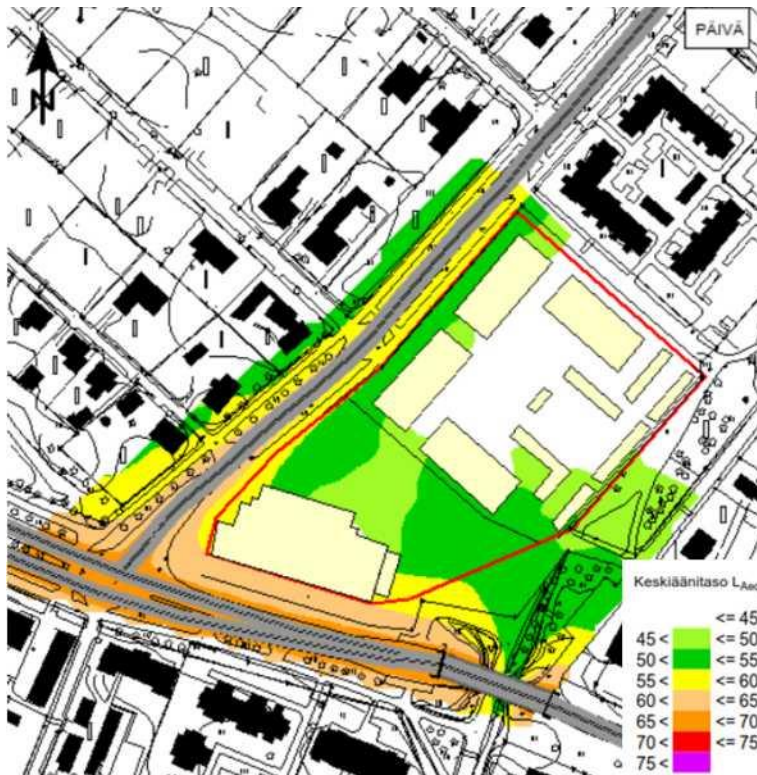
Kuva: Päiväajan keskiäänitaso kaava-alueella vuonna 2040. Ote Kastellin liikenne- ja meluselvityksestä. (Kastellin Liikekeskus Oy, Rakennusliike Lapti Oy, Sitowise Oy 26.1.2021, päivitetty 18.5.2022.)
