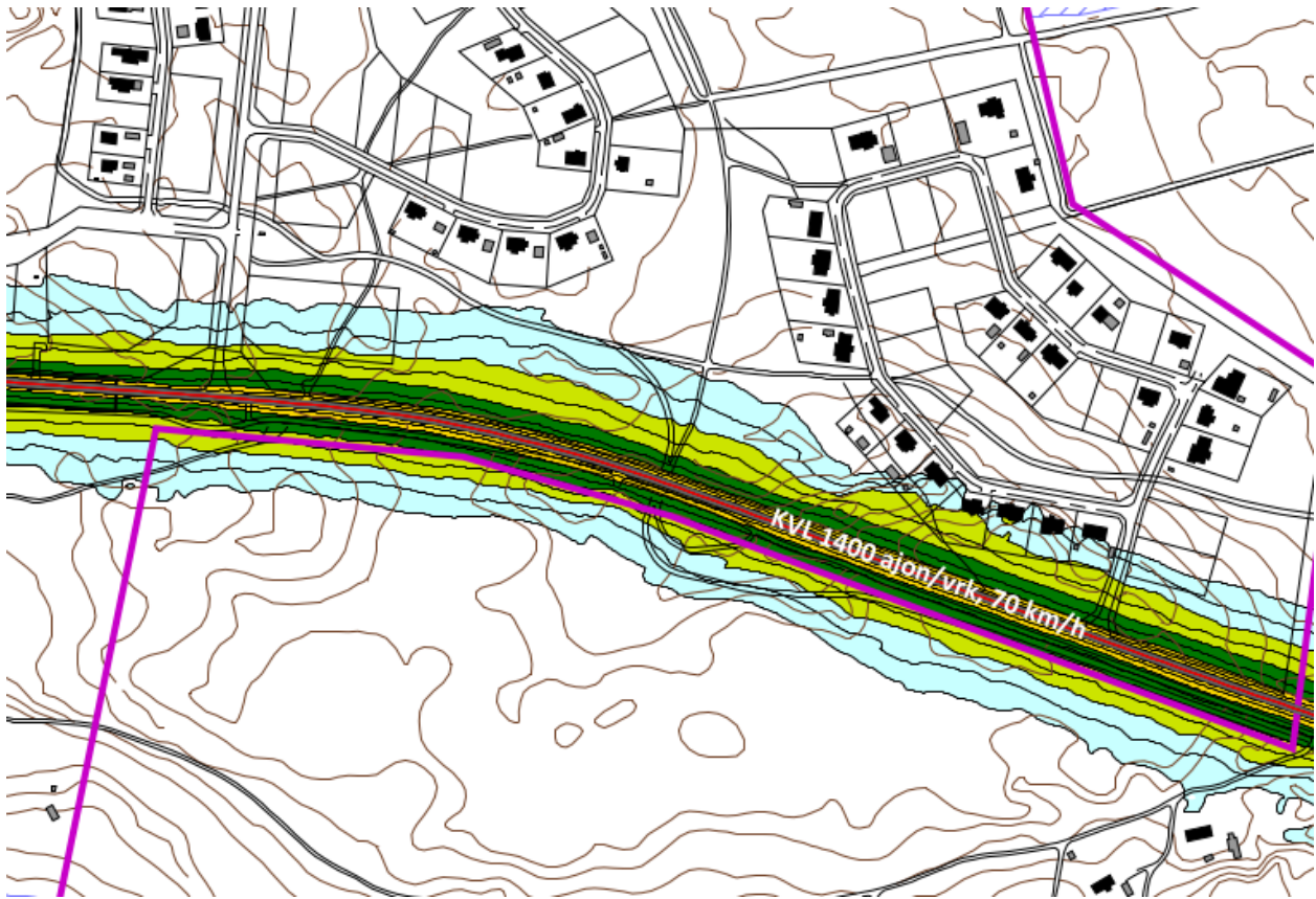
Kuva 31: Ote meluselvityksen liitekartasta 4, Kellonlahden kohdalta. Kartalla näkyy ennuste vuoden 2040 yöajan keskiäänitasoista eri väreillä. Kartalla vaaleanvihreä ja vaaleansininen alue ovat alle 50 dB alueita (Ramboll Finland Oy, 18.11.2022).
