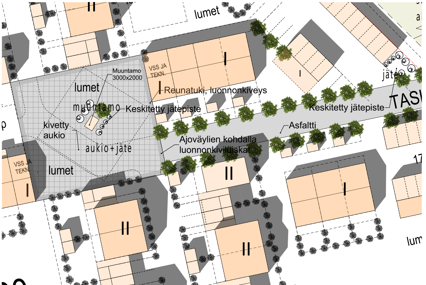
Periaate kuva aukiosta ja jätteiden yhteiskeräyspisteestä
