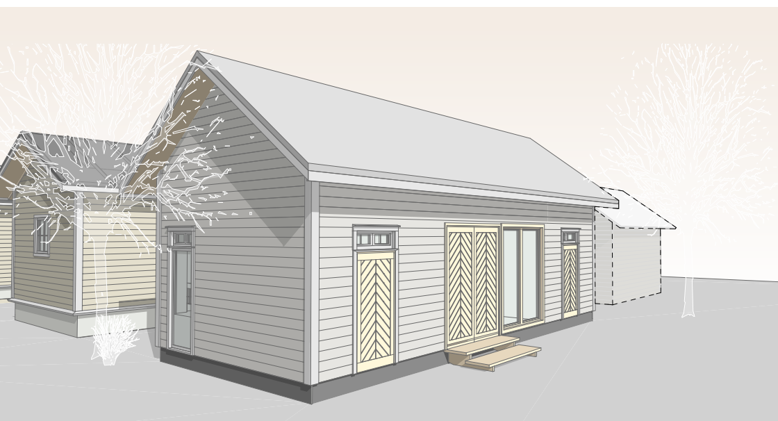
Kuva 87: Esimerkki asuin- käyttöön muuttamisesta. Rakennus muutostöiden jälkeen. Asunnoksi muu- tettu talousrakennus ei ole muuttunut ulkoisesti. Rakennuksen keskellä ollut autotalli on muutettu valo- saksi terassiksi. Tarpeetto- maksiksi jääneet vanhat ovet on joko jätetty paikoilleen, tai korvattu ikkunoilla, ku- ten rakennuksen päädyssä on tehty.
