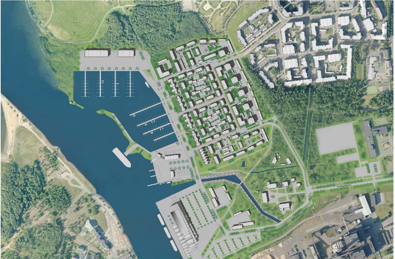
Kuva. Suunnitelman illustrationin ilmakuvaopetus. Parhaiten alue on suojattu pohjoisia, läntisiä ja kaakkoisia tuulia vastaan. Avoimia suuntia ovat sektori lounaasta luoteeseen ja pieni avoin alue koilliseen.
