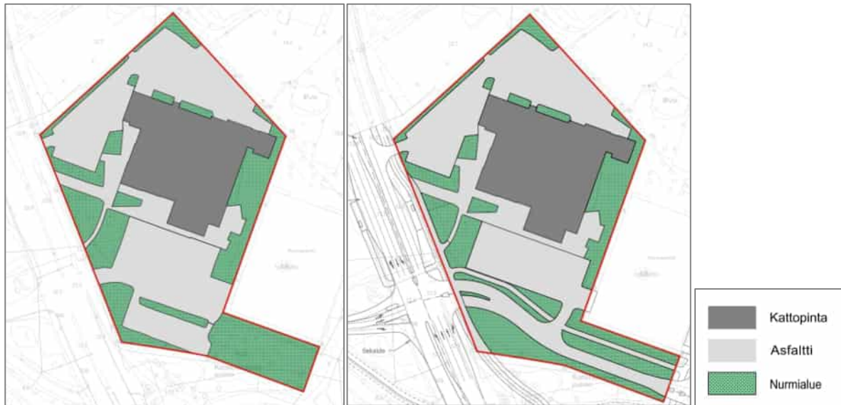
Kuva 15. Hulevesilaskennassa käytettyjen pintojen sijoittuminen selvitysalueella nykytilanteessa (vas. ruutu) sekä rakentamisen jälkeen (oik. ruutu). Nykytilanne perustuu kantakarttaan ja ilmakuviin. Rakentamisen jälkeinen tilanne perustuu yleissuunnitelman luonnokseen.
