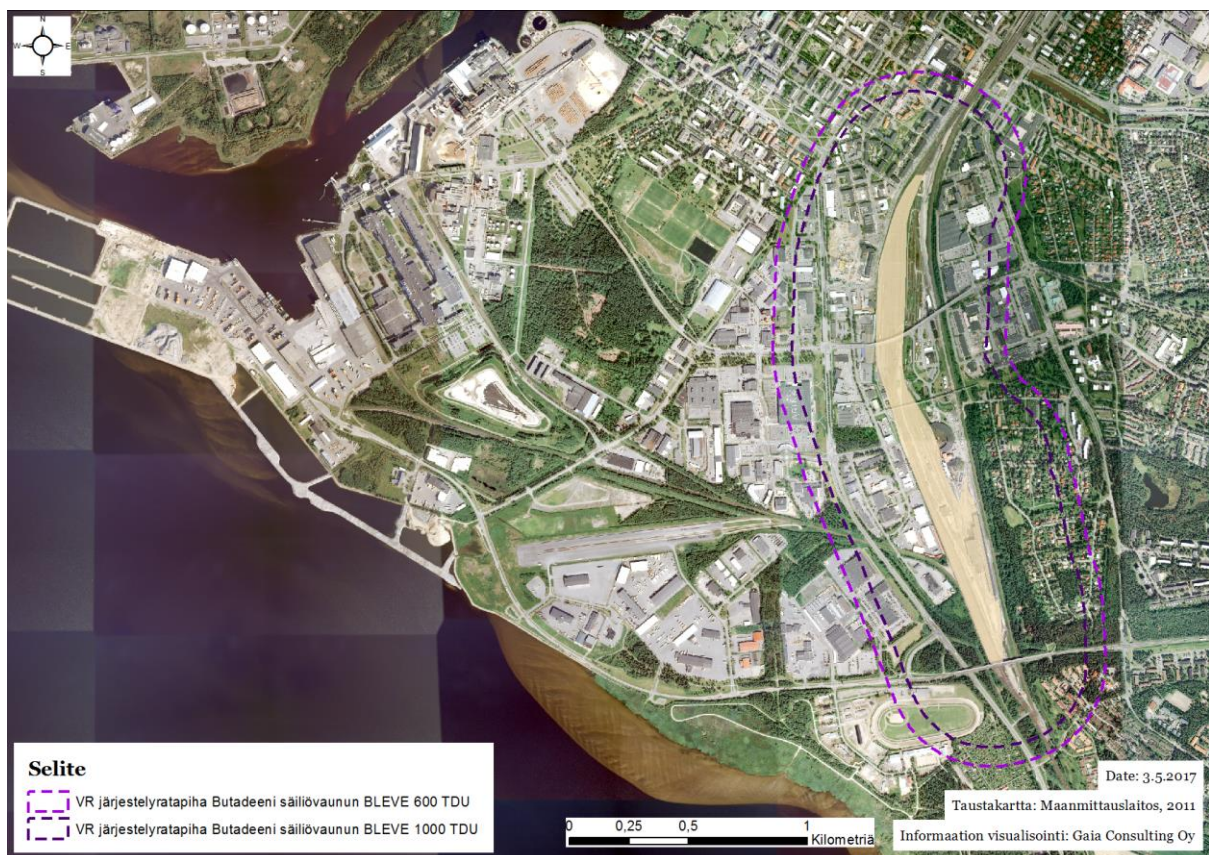
Kuva L7.1. Ratapihalla tapahtuva butadieenin säiliövaunun BLEVE
