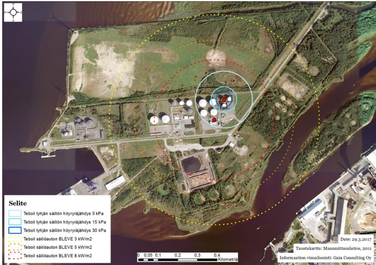
Kuva L6.1. Oy Teboil Ab:n tyhjän säiliön höyryräjähdysten sekä säiliöauton repeämisen (BLEVE) vaikutusetäisyydet.
