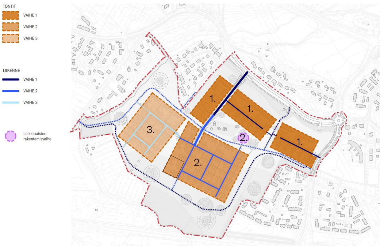
Kuva 8 Alueen rakentamisen vaiheistus (Arkkitehtitoimisto Harris-Kjisik Oy, 16.12.2022)
