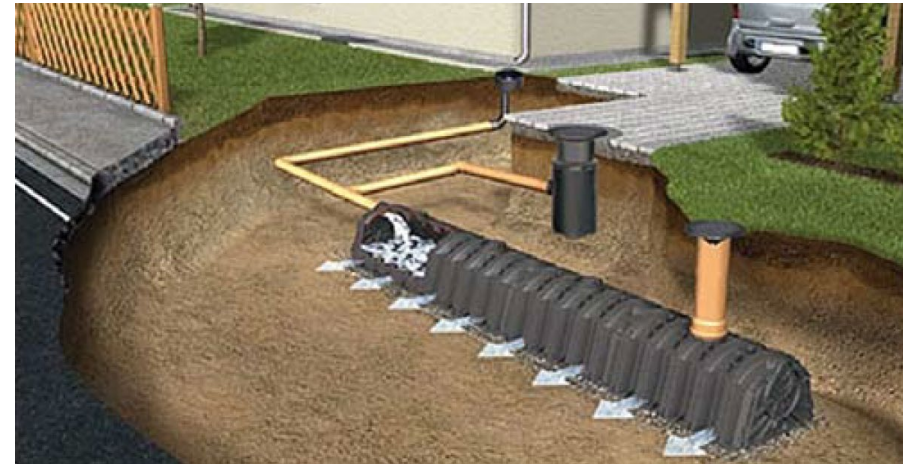
Hulevesitunneli (Rakennustieto Oy)
