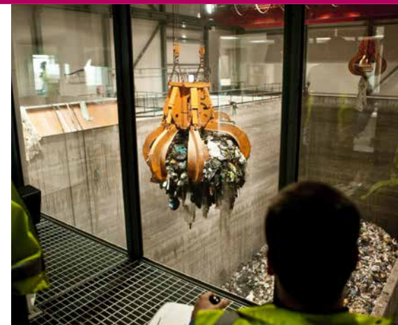
Laanilan ekovoimalaitoksen kahmariin on laskettu mahtuvan yhden ihmisen kymmenen vuoden aikana tuottamat jätteet. Tilastollisesti ihminen tuottaa vuodessa noin 300-500 kg jätettä ja kahmariin mahtuu 4 000 kg jätettä kerrallaan. Yksi kahmarillinen menee kattilaan n. 10-15 min välein. kuva Kati Leinonen
