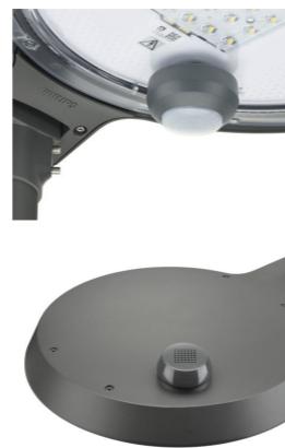
Kuva 2. Town tune valaisimeen kiinnitettävä Zhaga-ohjain, jolla valaistusta voidaan himmentää kaupungin ulkovalaistusverkon himmennysprofiilin mukaan. Zhaga-liittimen tulee olla valmiina kaikissa alueelle asennettavissa pylväsvalaisimissa.
