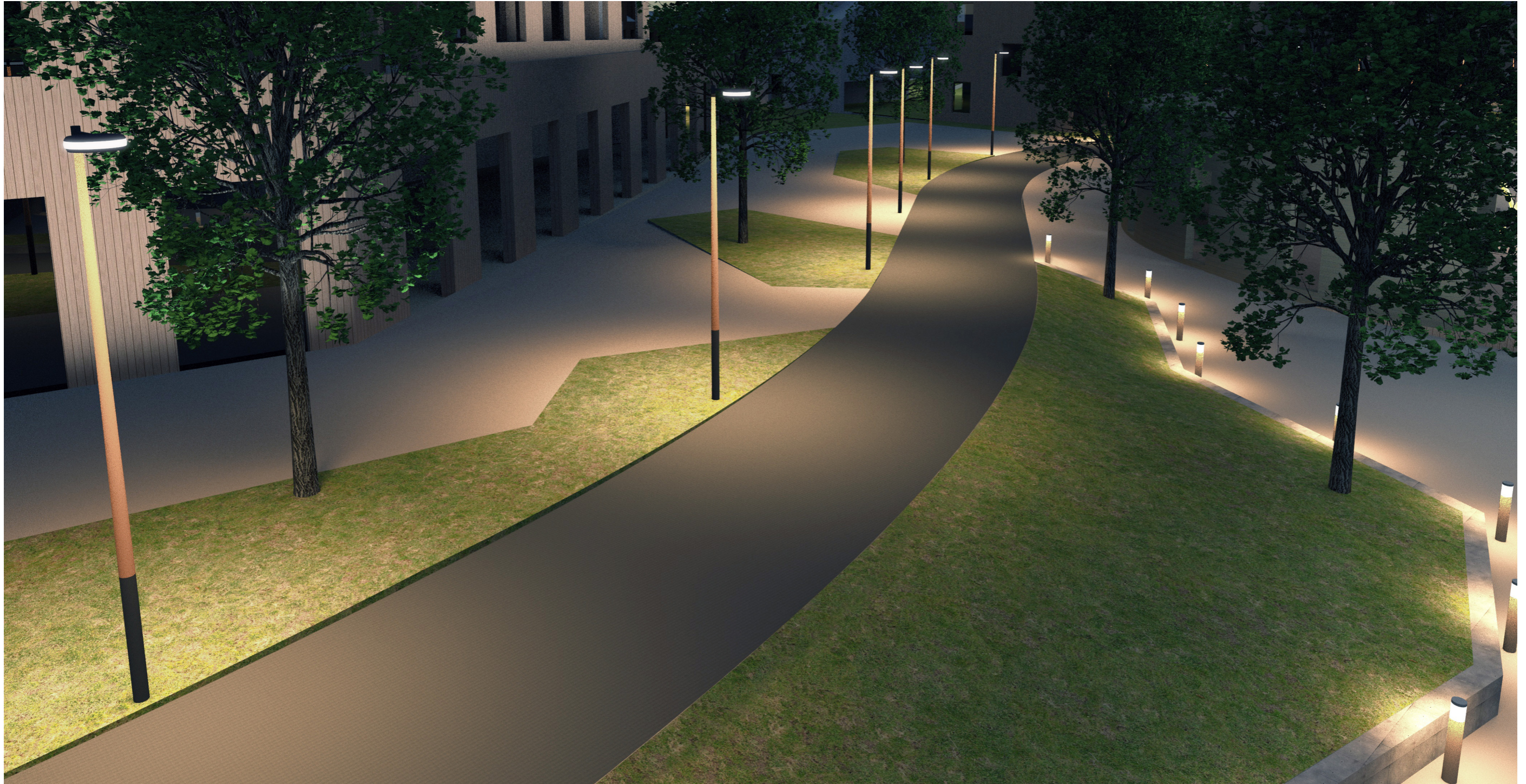
Kuva 1. Havainnekuva Vaakunakylänrannan kevyenliikenteenväylältä. Kuvassa yksipuolinen Atelje Lyktan Skipper- valaisin 6 metrin puupylväässä sekä Began pollarivalaisin. Havainnekuva WSP Finland Oy.
