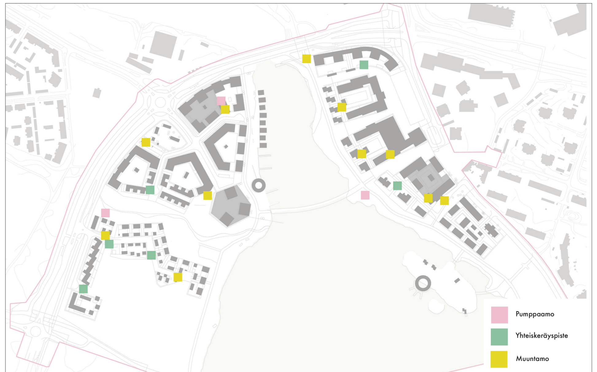
Kuva 88. Kartalla esitettynä muuntamot, pumppaamot ja yhteisjätekeräyspisteet
