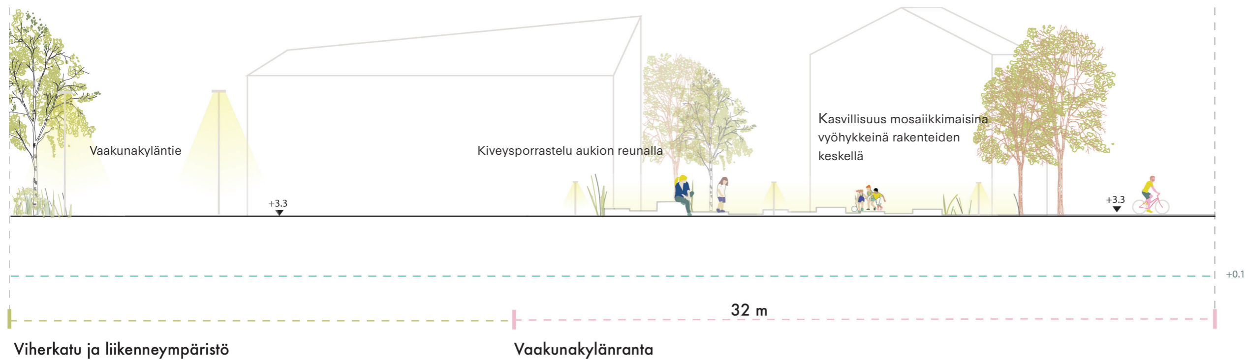
Kuva 58. Periaatteellinen leikkaus H-H Vaakunakylänrannan ja Vaakunakyläntien yhtymäkohdasta 1:200
