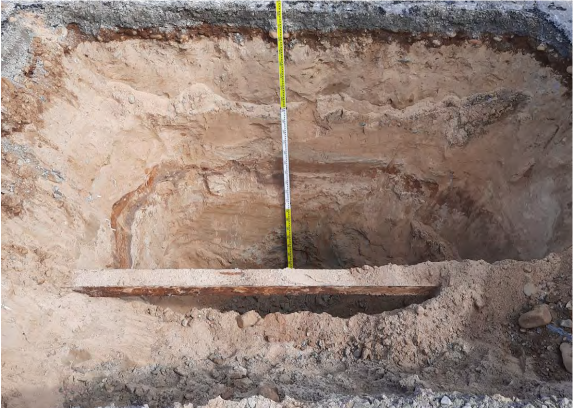
Kuva 5. Koekuoppa 12 kaupungin varikon alueella. Kuopassa metallinen palkki.
