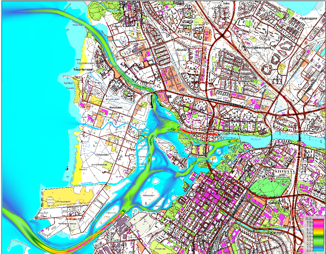
Kuva 22. Virtausnopeus*vesisyvyys [ \text{m}^2/\text{s} ] mallinnustapauksessa 2C1: ylivirtaama HQ_M ja keskialivesi MNW, nykytila (topografia C1). Vesisyvyydellä kerrottu virtausnopeus kuvaa virtaamaa paremmin kuin pelkkä virtausnopeus.
