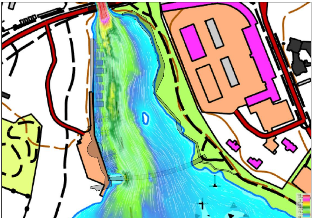
Kuva 25. Virtausnopeus*vesisyvyys [ m^2/s ] mallinnustapauksessa 2B2: ylivirtaama HQ_M ja keskialivesi MNW, topografia B2. Ylivirtaamatilanteessa sillan länsityven louhepenger suojaa lähinnä lähimpiä venelaitureita sekä rannan puoleisen päädyn venepaikkoja.
