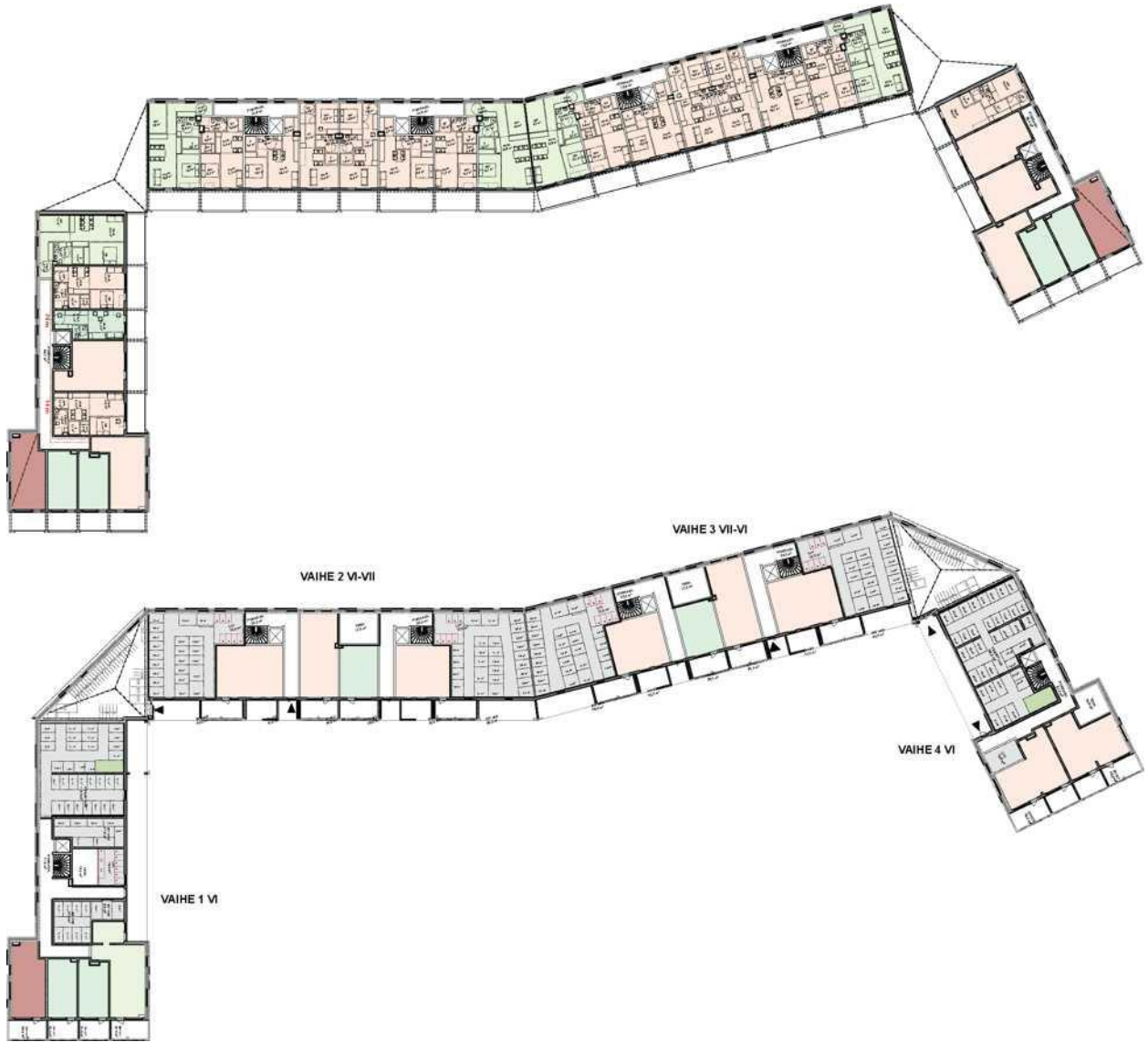
Kuva: Asuinrakennuksen pohjakaaviot: yllä kerrokset 2–6 ja alla pohjakerros. (Rakennusteho Group Oy, Arkkitehtitoimisto Vauhtiviiva Oy 2022.)
