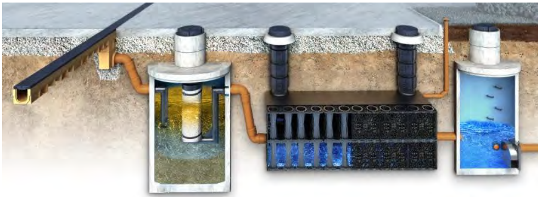
Kuva 10 Hulevesikasettijärjestelmä hulevesien imeytykseen/viivytykseen (ACO Nordic Oy) kuvassa vasemmalta – oikealle: linjakaivo – erotuskaivo – viivytyskasetti – virtaukensäätökaivo
