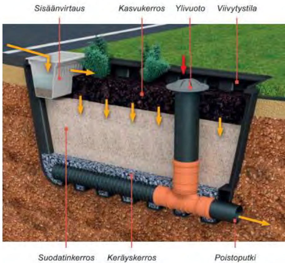
Kuva 9 Uponor Rain Garden suodatinjärjestelmän osat ja toiminta, joka perustuu biosuodatukseen.
