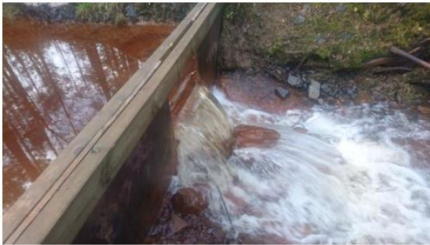
Kuva 2. Leppisuonojan tutkimuspato. Ojaa on padotettu 0,5 metriä. Tutkimuksella seurataan, vaikuttaako padotus raudan kulkeutumiseen.
