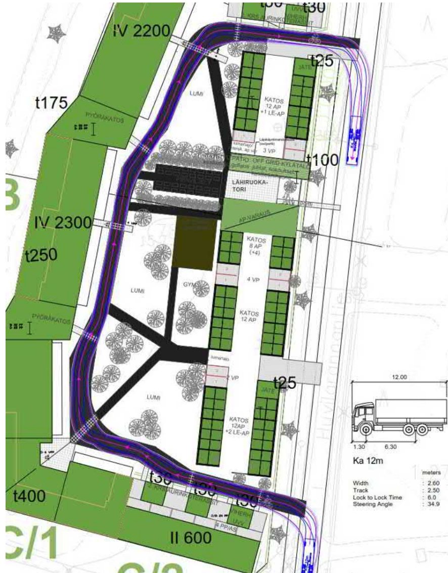
Kuva 8. Mitoituskuorma-auton (pituus 12 m) kulku pelastustiellä.
