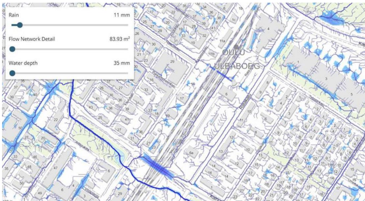
Kuva 17. Oulun asemanseudun ympäristön pintavirtausreitit ja tulvivat alueet Scalgo Live -palvelusta. (Oulun kaupunki)
