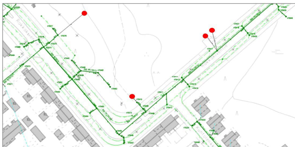
Kuva 15 Ote hulevesiselvityksestä. Selvitysalueen hulevesiverkko (Oulun kaupunki). Selvitysalueen tonteille rakennetut liittymät esitetty punaisella.
