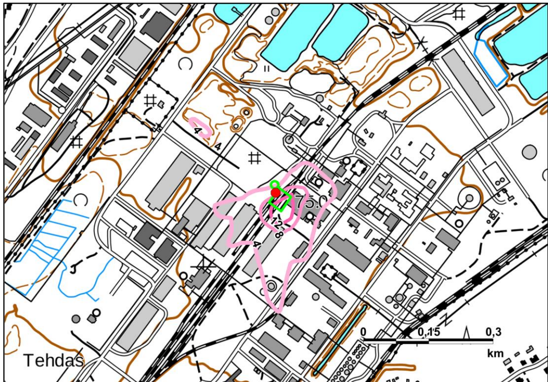
Kuva 49. Laanilan teollisuusalueella sijaitsevan biojätteen käsittelylaitoksen pölypäästön ( 5 \text{ mg/m}^3 ) aiheuttama ulkoilman ohjearvoon 70 \text{ } \mu\text{g/m}^3 verrannollinen pölypitoisuus (vuorokausikeskiarvo) hankevaihtoehdossa VE2. Päästölähde (poistoilmakanava, virtaus 50\,000 \text{ m}^3/\text{h} ) on merkitty punaisella pisteellä.
