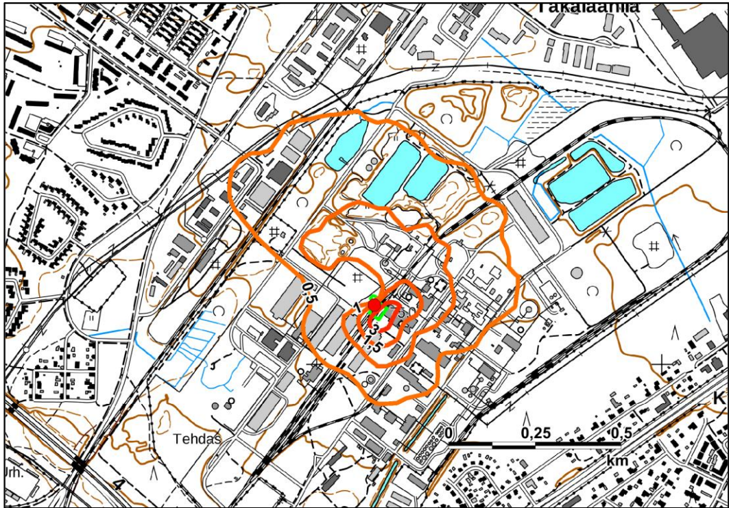
Kuva 47. Laanilan teollisuusalueella sijaitsevan biojätteen käsittelylaitoksen hajupäästön 1\ 000 hajuyksikköä/ m^3 aiheuttama ulkoilman hajupitoisuus (tuntikeskiarvon 98 prosenttipiste) leviäminen ulkoilmassa hankevaihtoehdossa VE2. Päästölähde (biojätteen käsittelylaitoksen poistoilmakanava, virtaus 50\ 000\ m^3/h ) on merkitty punaisella pisteellä.
