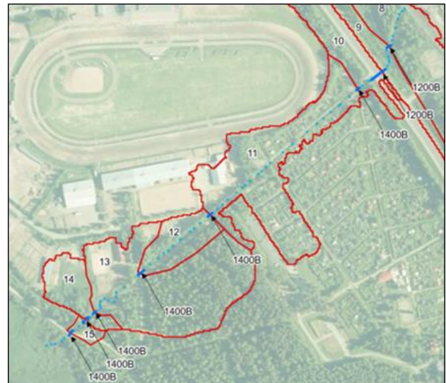
Kuva 48. Purkureitin varrella rumpujen mitoitukset, joilla purkureitin kapasiteetti on riittävä kerran 100 vuodessa toistuvassa rankkasadetilanteessa.
