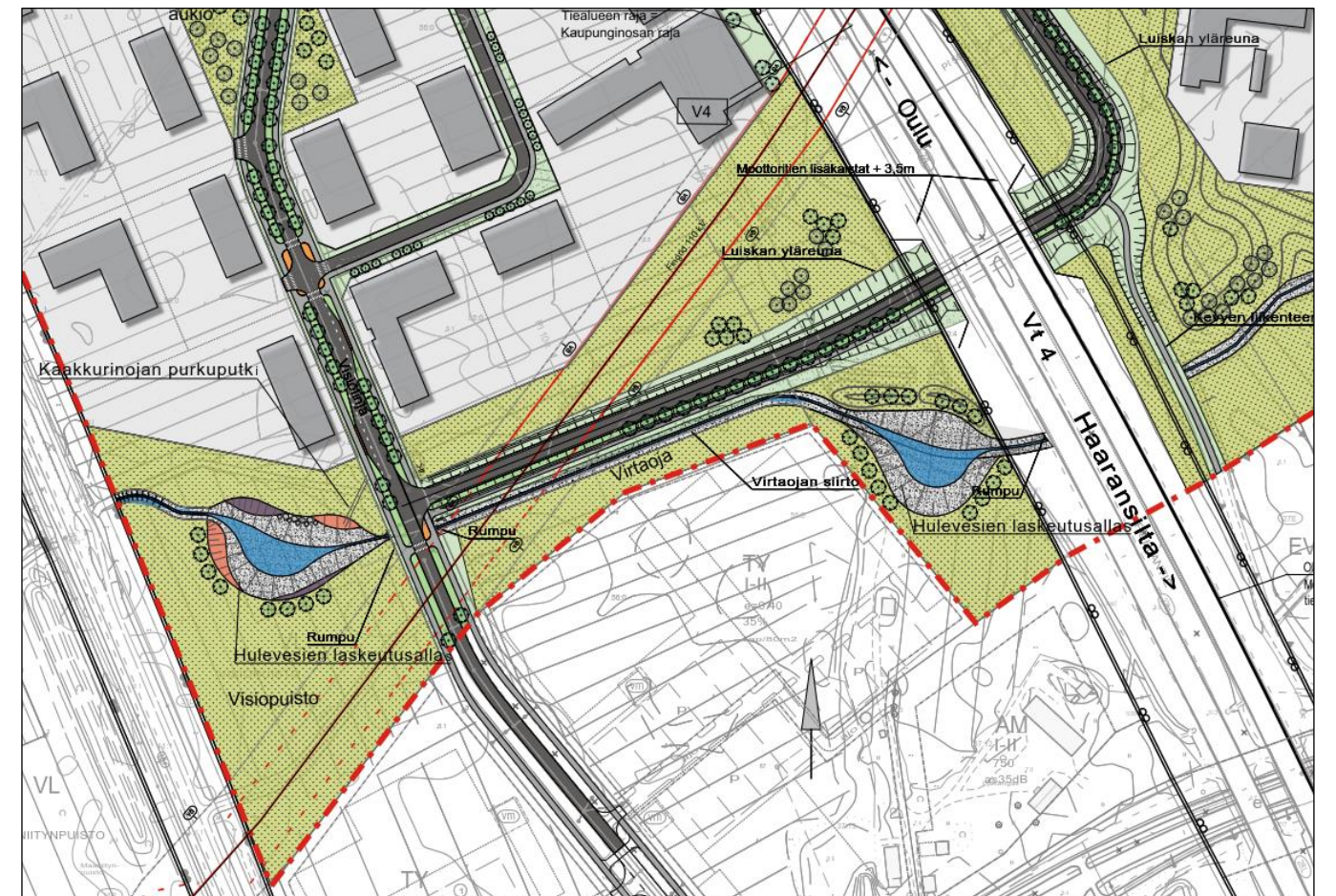
Kuva 69. Periaatekuva Visiipuiston käsittelystä. Puiston halkaisee Virtaoja, jonka yhteyteen muotoillaan hulevesien viivytyksainanteita. Puiston halkaisee Fingridin 110 kV:n voimalinja
