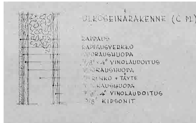
Kuva 208. Irma Mikkolan vuonna 1952 suunnitteleman Upseeritalon seinärakenne on sisältä lukien seuraava: \frac{3}{8} tuuman kipsonit, \frac{7}{8} x 4 tuuman vinolaudoitus, vuoraushuopa, 5 tuuman runko + täyte, vuoraushuopa, \frac{7}{8} x 4 tuuman vinolaudoitus, vuoraushuopa, rappausverkko ja rappaus. Karjasillan puukerrostaloista vain kyseinen Upseeritalo on rapattu.
