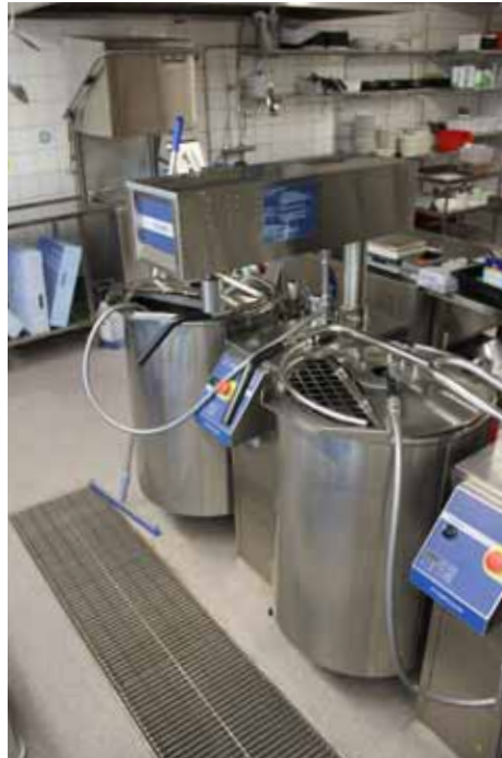
198. Lattia on päällystetty akryylimassalla.
