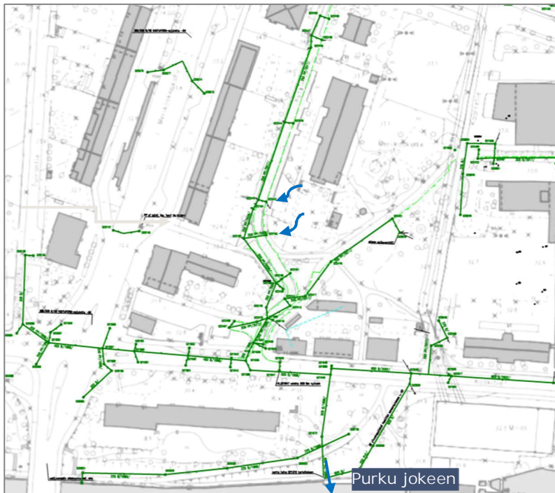
Kuva 3. Selvitysalueella sijaitseva hulevesiverkosto. (Oulun kaupunki)
