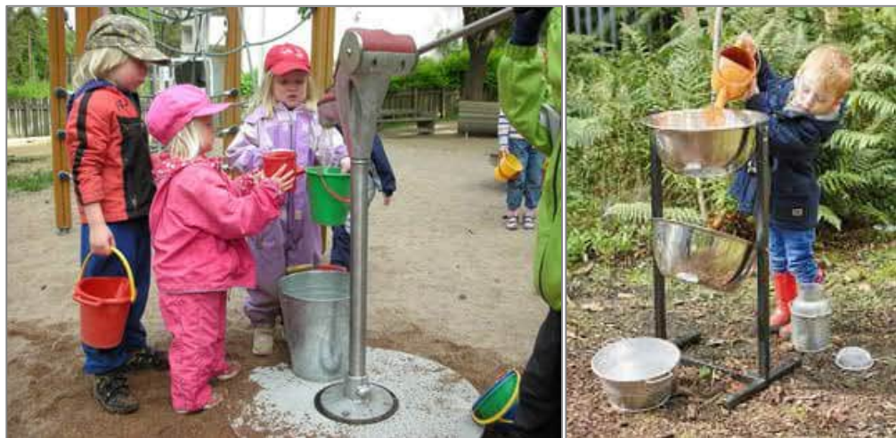
Kuva 12. Leikkikenttäpumpulla voidaan nostaa vettä myös maanalaisesta säiliöstä. Kuvat vasemmalta: Nira Pumps Oy, Lekolar.
