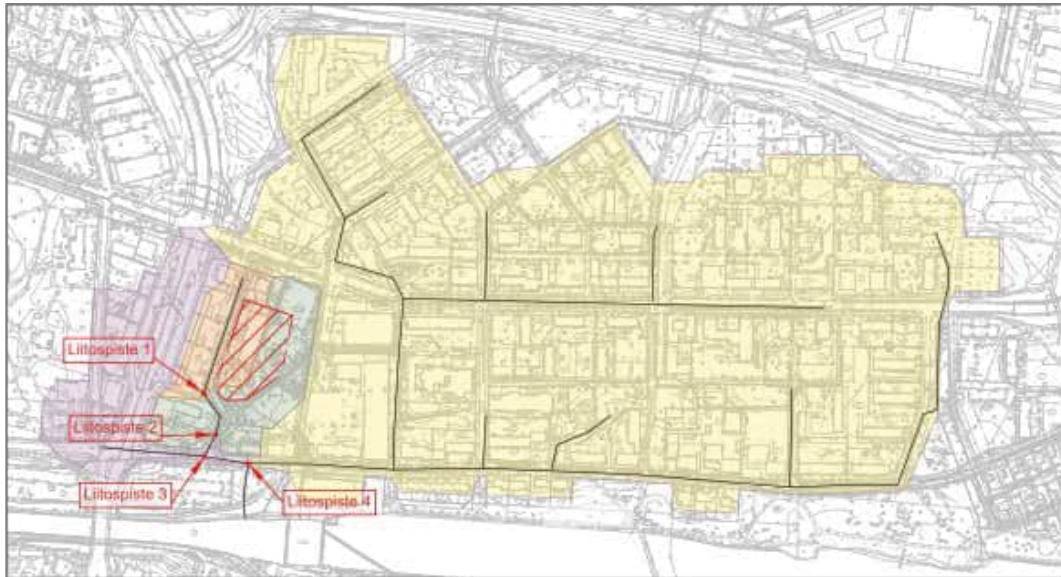
Kuva 7. Koskitien hulevesiviemärin kapasiteetin arvioimisessa käytetyt osavaluma-alueet sekä liittospisteet.
