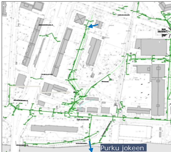
Kuva 3. Selvitysalueella sijaitseva hulevesiverkosto. (Oulun kaupunki)
