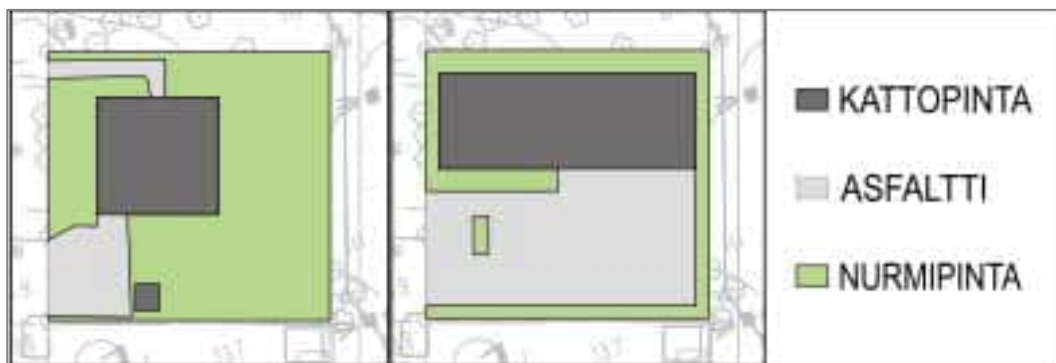
Kuva 6. Hulevesilaskennassa käytettyjen pintojen sijoittuminen selvitysalueella nykytilanteessa (vas. ruutu) sekä rakentamisen jälkeen (oik. ruutu). Perustuu käyttösuunnitelmaan (kuva 5).
