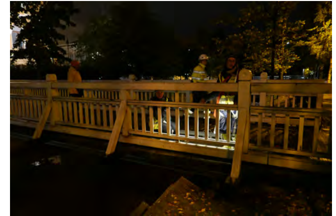
Kuva 35. Puusillan kaiteen koevalaistus lämpimällä valkoisella valolla. Testattavana LiniLED Deco.
