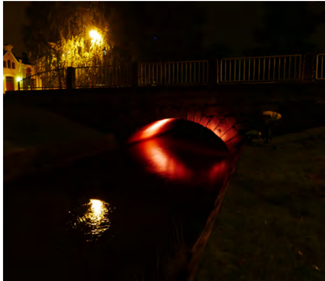
Kuva 33. Kivisillan holvikaaren koevalaistus, jossa valaisin suunnattu suoraan kaariholviin. Testattavana Philips Color Burst Powercore.
