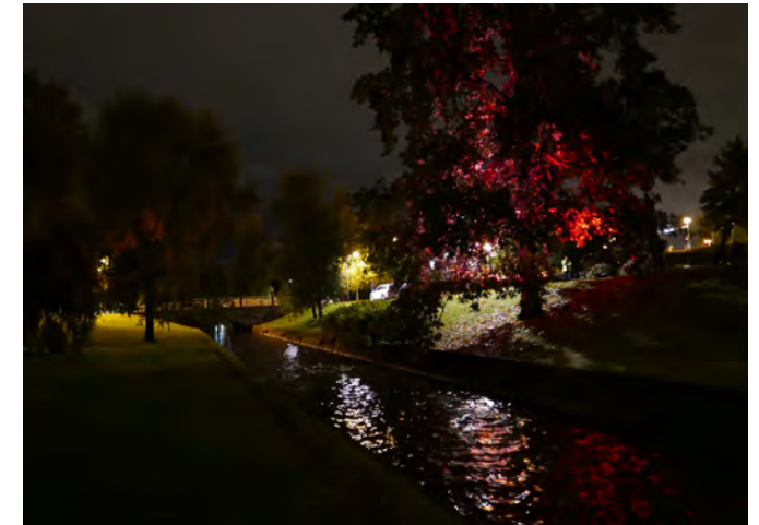
Kuva 43. Puun koevalaistus punaisen eri sävyillä. Testattavana Meyer Lighting Superlight Nano 4 ja Philips Color Burst Powercore.
