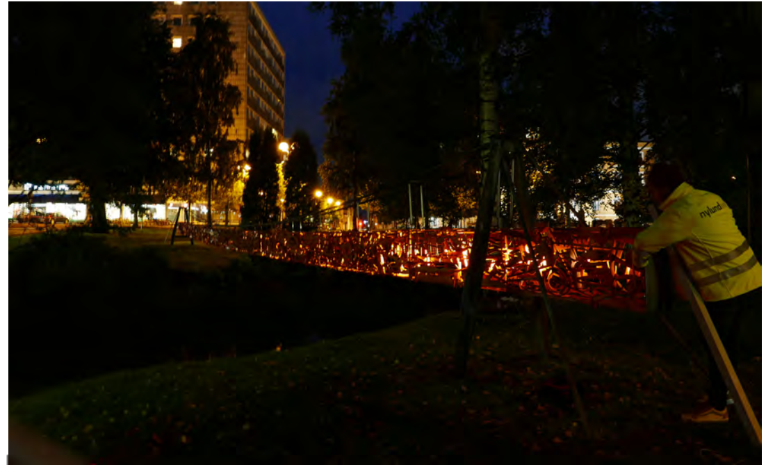
Kuva 52. Mediatorin koevalaistus kapeakeilaisella heittimellä. Testattavana Meyer Ecospot Mini.
