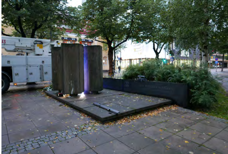
Kuva 49. Jääkärimuistomerkin koevalaistus ohjelmoitavalla RGB-valaisimella. Testattava valaisin Philips iWGraze.
