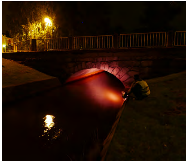
Kuva 34. Kivisillan holvikaaren koevalaistus, jossa valaisin suunnattu veden kautta kaariholviin. Testattavana Philips Color Burst Powercore.
