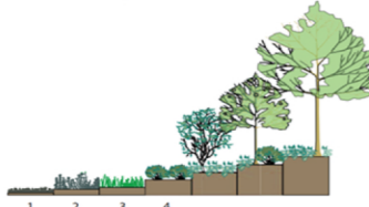
Kuva 6. Viherkattotyypin 1-4 kasvualustapaksuudet: 1. maksaruohokatto 60...80 mm 2. niitty/ketokatto 150...200 mm 3. heinäkatto 200...300 mm 4. kattopuutarha 200...1000 mm kasvilajikohtaisten vaatimusten mukaan
