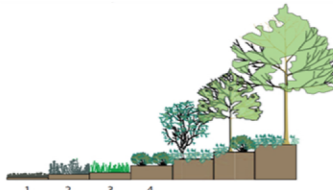
Kuva 6. Viherkattotyypin 1-4 kasvialustapaksuudet: 1. maksaruohokatto 60...80 mm 2. niitty/ketokatto 150...200 mm 3. heinäkatto 200...300 mm 4. kattopuutarha 200...1000 mm kasvialajikohtaisten vaatimusten mukaan
