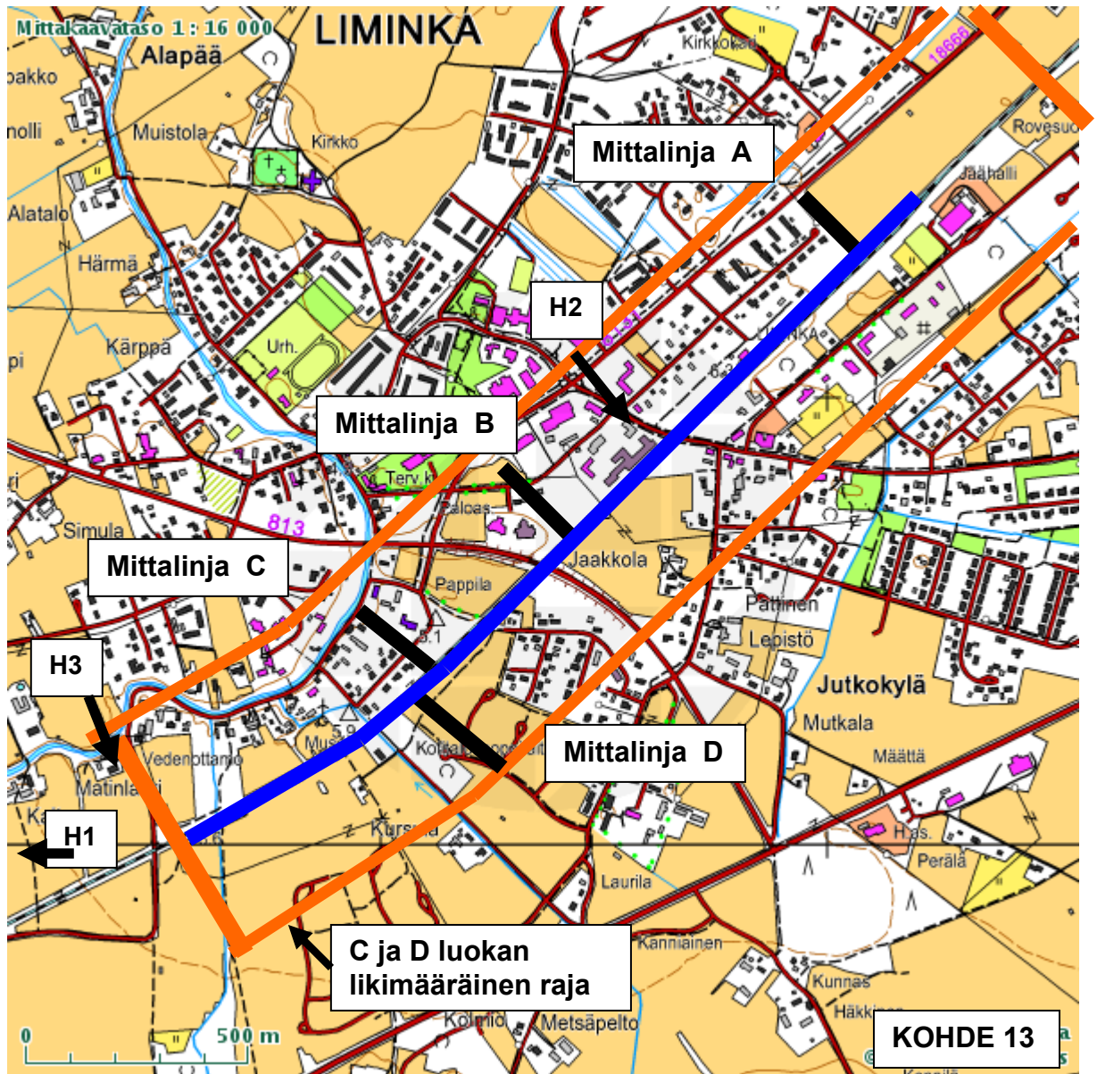
Kuva 10. Tärinän riskialue Limingassa. Poikkiviivat radan kohdalla rajaavat tarkastelualueen. Värähtelyluokkien D ja C välinen raja on merkitty kuvaan likimääräisesti. Värähtelyluokka D on lähempänä rataa, rajan sisällä. Ehdotus tärinän vähentämistoimenpiteiden likimääräiseksi sijainniksi on merkitty kuvaan sinisellä.
