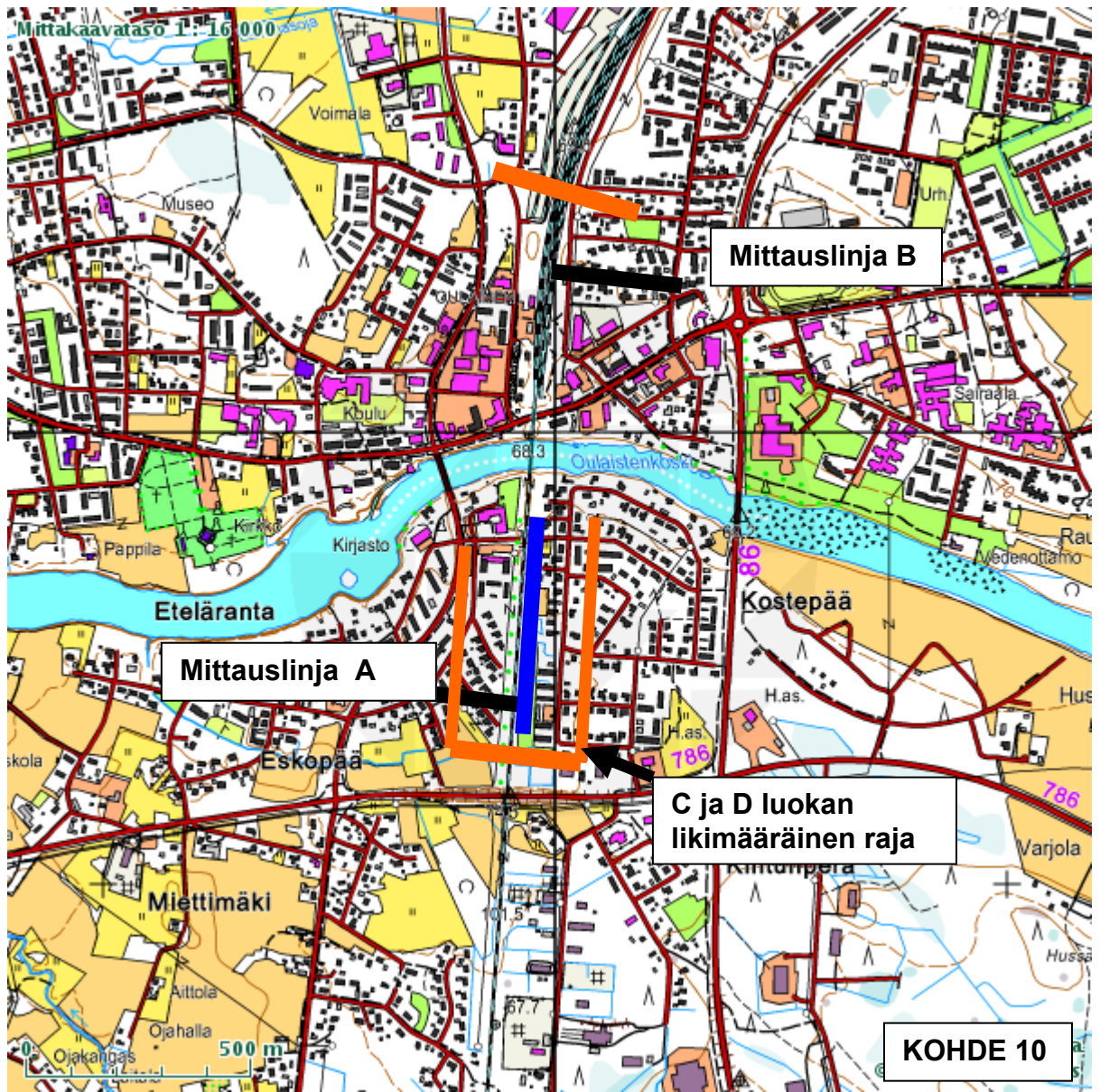
Kuva 1. Tärinän riskialue Oulaisissa. Poikkiviivat radan kohdalla rajaavat tarkastelualueen. Värähtelyluokkien D ja C välinen raja on merkitty kuvaan likimääräisesti. Värähtelyluokka D on lähempänä rataa, rajan sisällä. Ehdotus tärinän vähentämistoimenpiteiden likimääräiseksi sijainniksi on merkitty kuvaan sinisellä.
