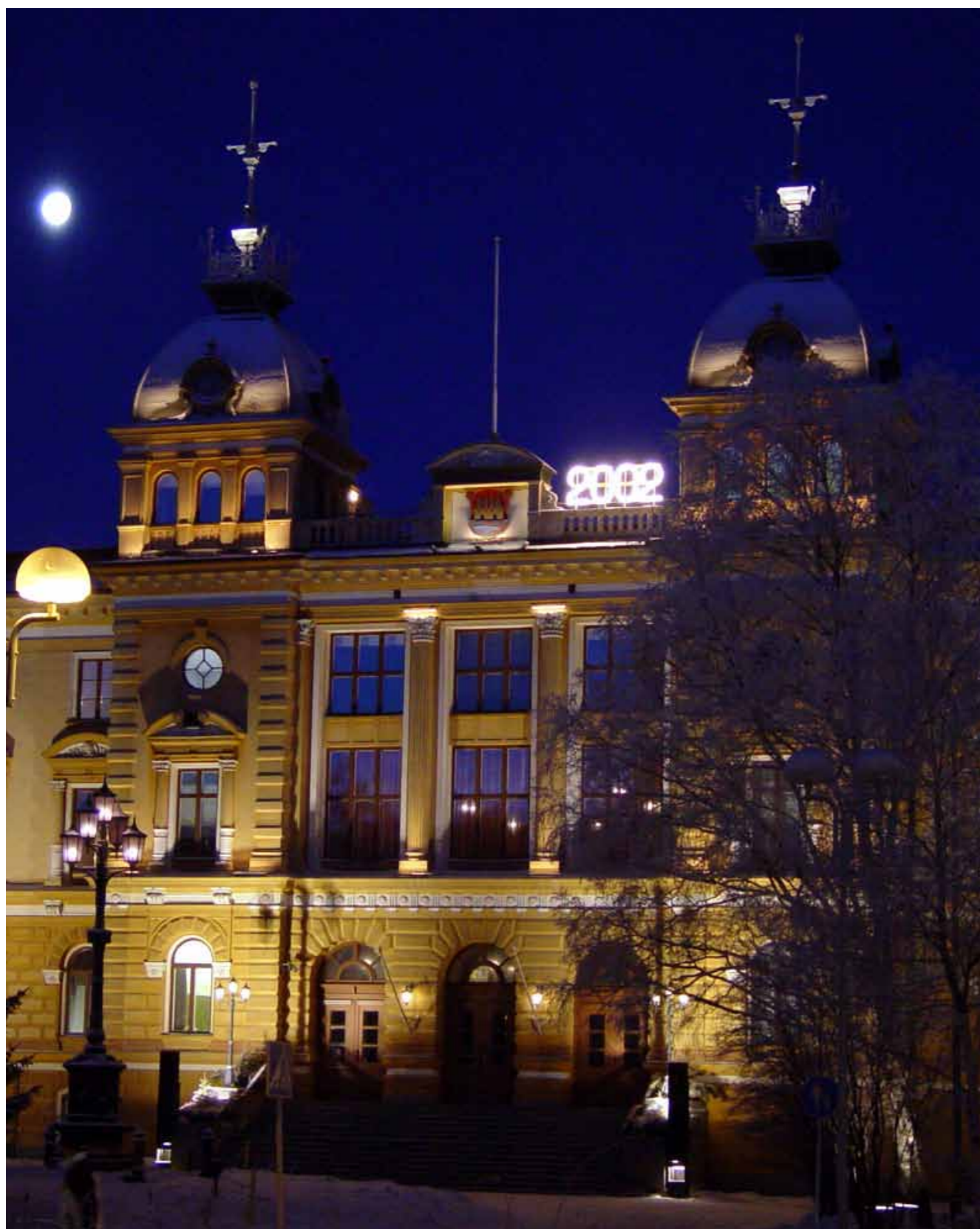
Kuva 48. Oulun kaupungin talon julkisivuvalaistus on toteutettu pehmeästi valonheittimin, joiden pylväsasennus on huomaamaton. Kuva Oulun kaupunki.
