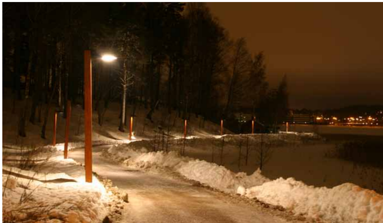
Kuva 68 (yllä). Rantapuiston valaistus on toteutettu häikäsemättömästi pollareilla. Valonjakopinnot eivät ole kävelijän katseen suuntaa. Valaistus korostaa myös maaastonmuotoilua. Lutakonpuisto, Jyväskylä.
