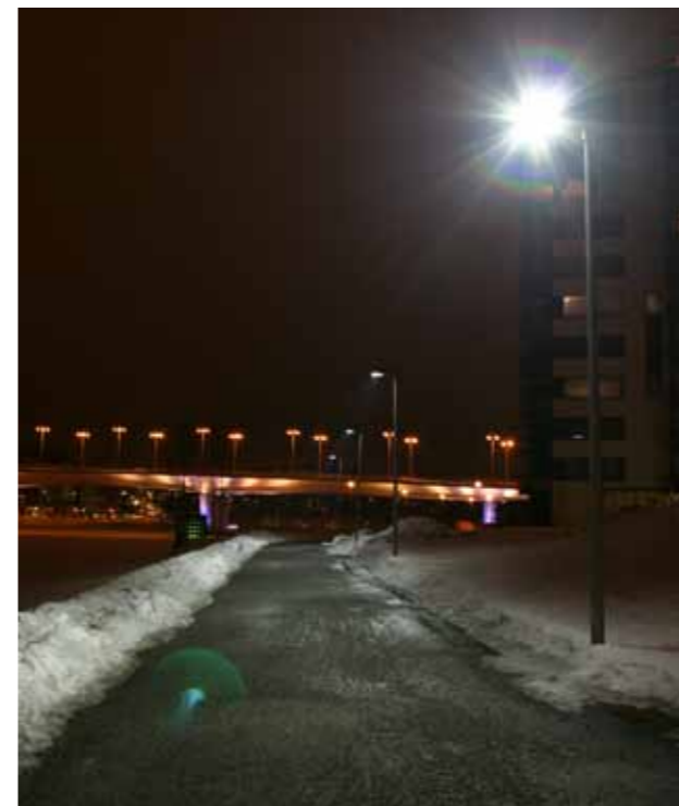
Kuva 38. Led-valaisimilla valaistu kevyenliikenteenväylä Lutakonjärven rannalla. Valaistus reitillä on tasainen, mutta valaisimet aiheuttavat häikäisyä muuten niukasti valaistussa rantaympäristössä. Jyväskylä.
