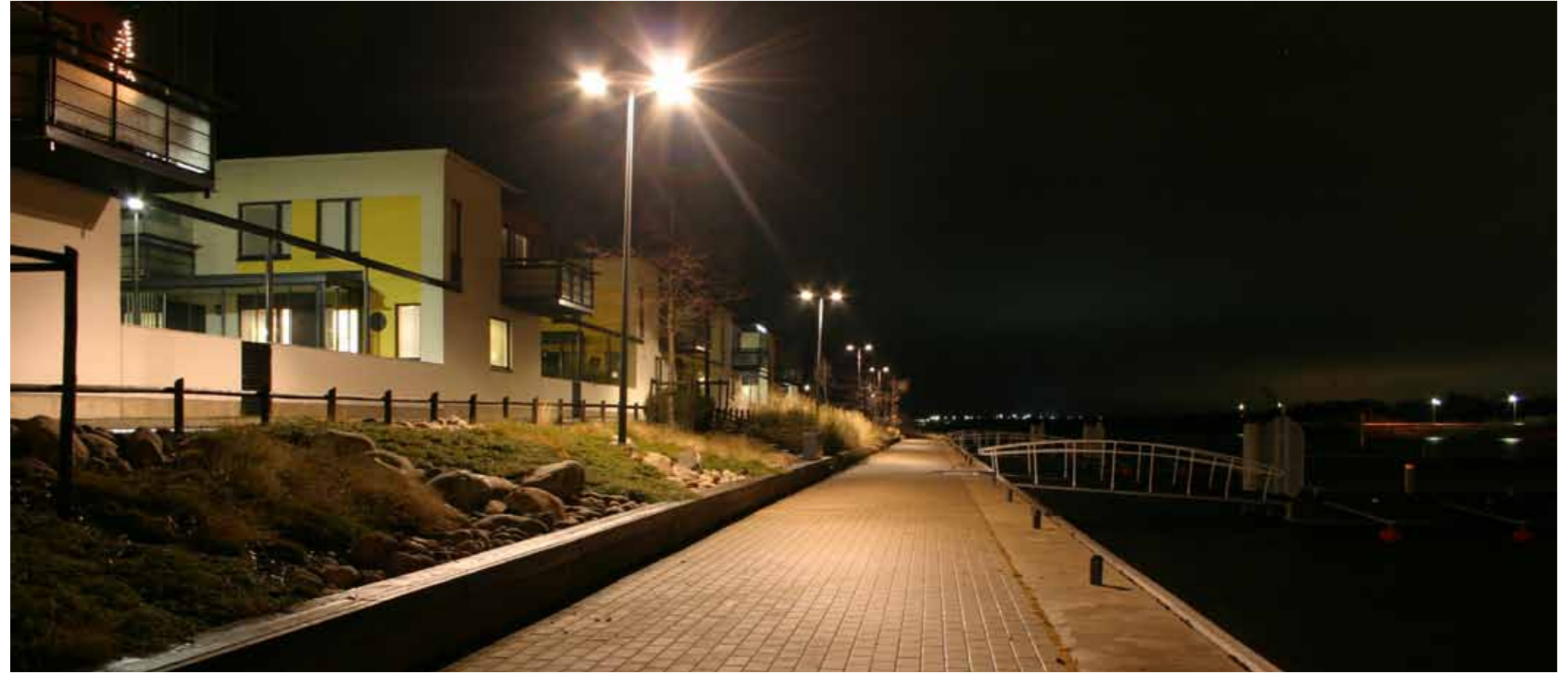
Kuva 11. Monimetallilamppuvalaistus, Toppilansaari Kuva 12. Elohopealamppuvalaistus, Karjasilta. Kuva 13. Jos eri valonlähteitä käytetään rinnakkain, silmän väriadaptaatio korostaa värieroa. Saapuminen elohopealampuilla valaistulta kevyenliikenteenväylältä. suurpainenatriumlampulla valaistulle kokoojakadulle. Karjasilta. Kuva 14. Suurpainenatriumlamppuvalaistus, Kuivasranta.
