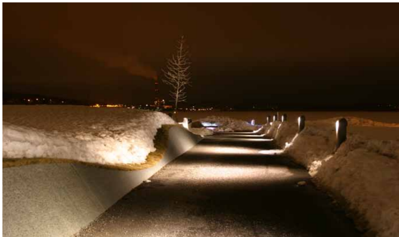
Kuva 68 (yllä). Rantapuiston valaistus on toteutettu häikäsemättömästi pollareilla. Valonjakopinnot eivät ole kävelijän katseen suuntaa. Valaistus korostaa myös maaastonmuotoilua. Lutakonpuisto, Jyväskylä.
