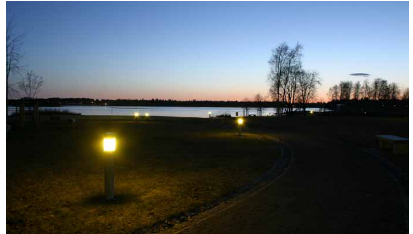
Kuva 103. Matalat pollarivalaisimet sopivat herkkään rantamaisemaan. Tämä valaisinmalli aiheuttaa kuitenkin liikaa häikäisyä. Kiikelinlahti.
