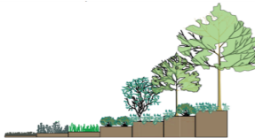
Kuva 6. Viherkattotyypin 1-4 kasvualustapaksuudet: 1. maksaruohokatto 60...80 mm 2. niittykattokatto 150...200 mm 3. heinäkatto 200...300 mm 4. kattopuutarha 200...1000 mm kasviliikkeitä vaativien vaatimusten mukaan
