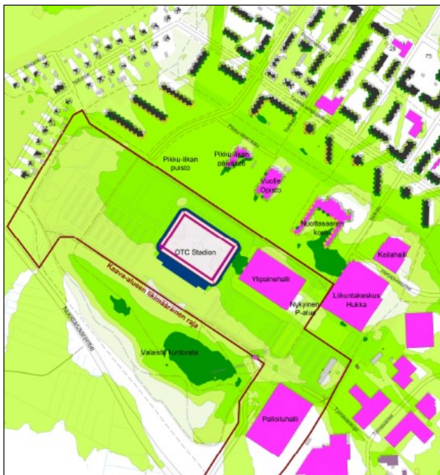
Kuva 25. Jalkapallo-ottelun aikainen keskiäänitaso.
