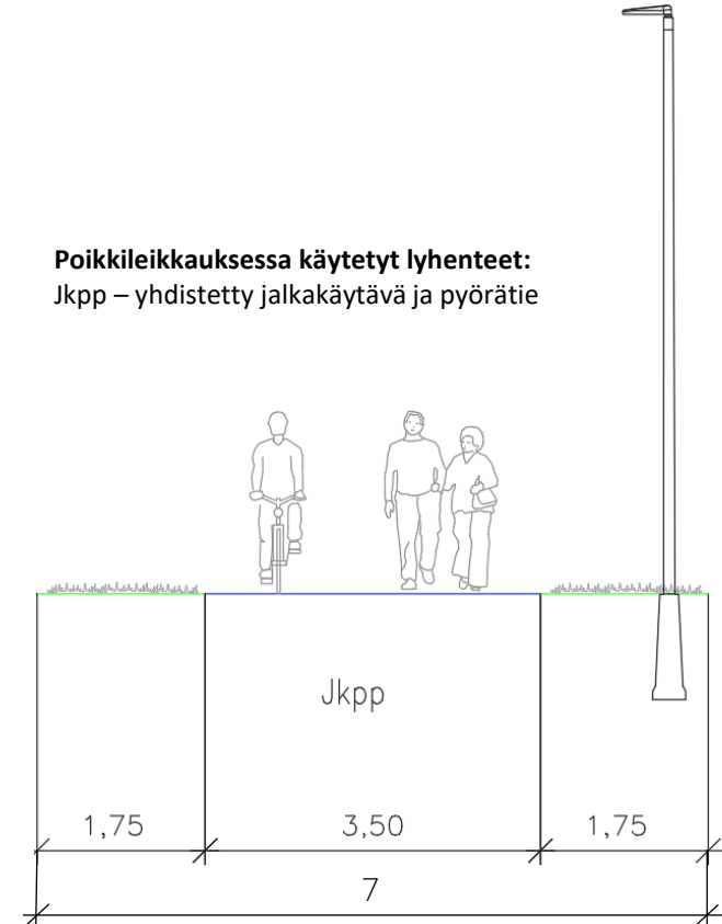
Kuva 11. Kuntoradan kesäaikainen poikkileikkaus. Kokonaisleveys 7 metriä. Poikkileikkauksessa ei ole esitetty latupohjan reuna-alueita.
