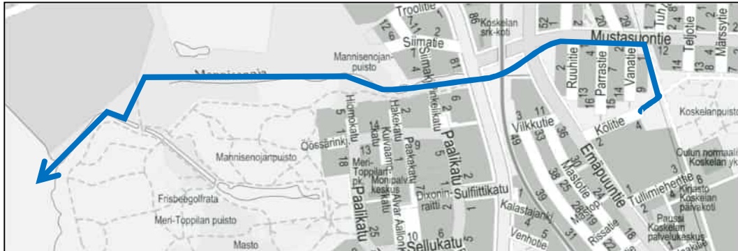
Kuva 3. Selvitysalueelta hulevesiverkostoon johdettavan huleveden reitti purkupisteeseen esitettyä kuvassa sinisellä viivalla. (reitti perustuu Oulun kaupungin aineistoon)
