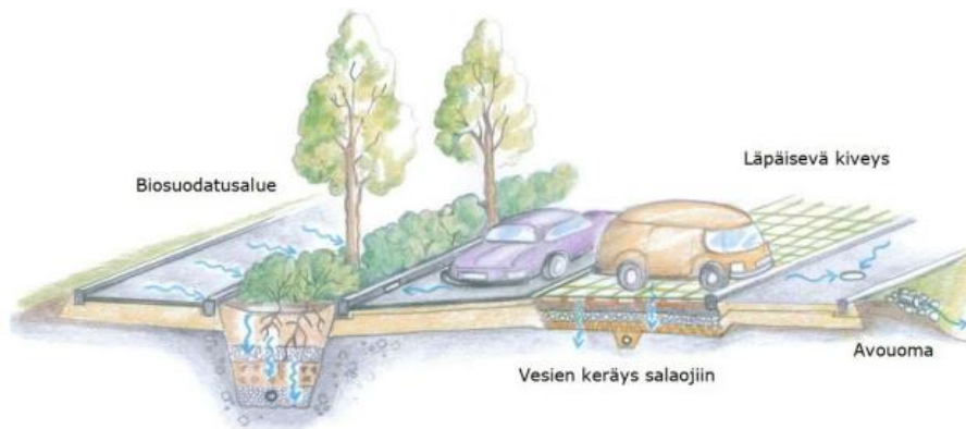
Kuva 8. Esimerkki läpäisevästä kiveyksestä ja suodatusalueesta (Lähde: Oulun viherkerrointyökalun käyttöohje)
