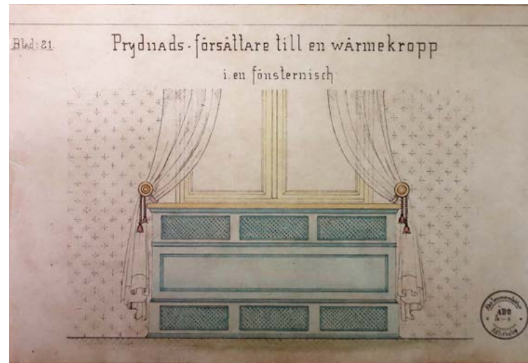
Lämpöpatterit sijoitettiin seinäsyvennykseen ikkunoiden alle. Kuvassa esitään patterin peittävä suojalevy. KUVA: Oulun Tilapalvelut arkisto
