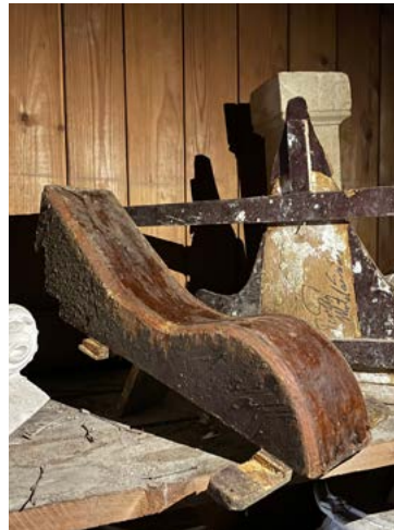
Uudet muotit on säilytetty myöhempiä korjauksia varten. Muotissa on Pentti Weteläisen signeeraus 1990
