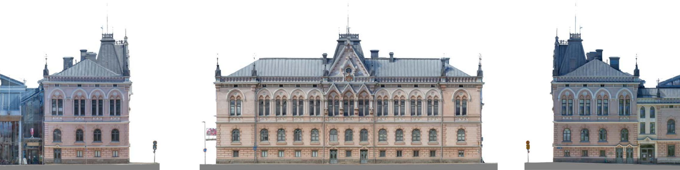
Kulttuuritalo Valveen vanhan osan fotogrammiset sivu- ja etuprojektit. KUVA: Oulun kaupunki, Tietoa Oy
