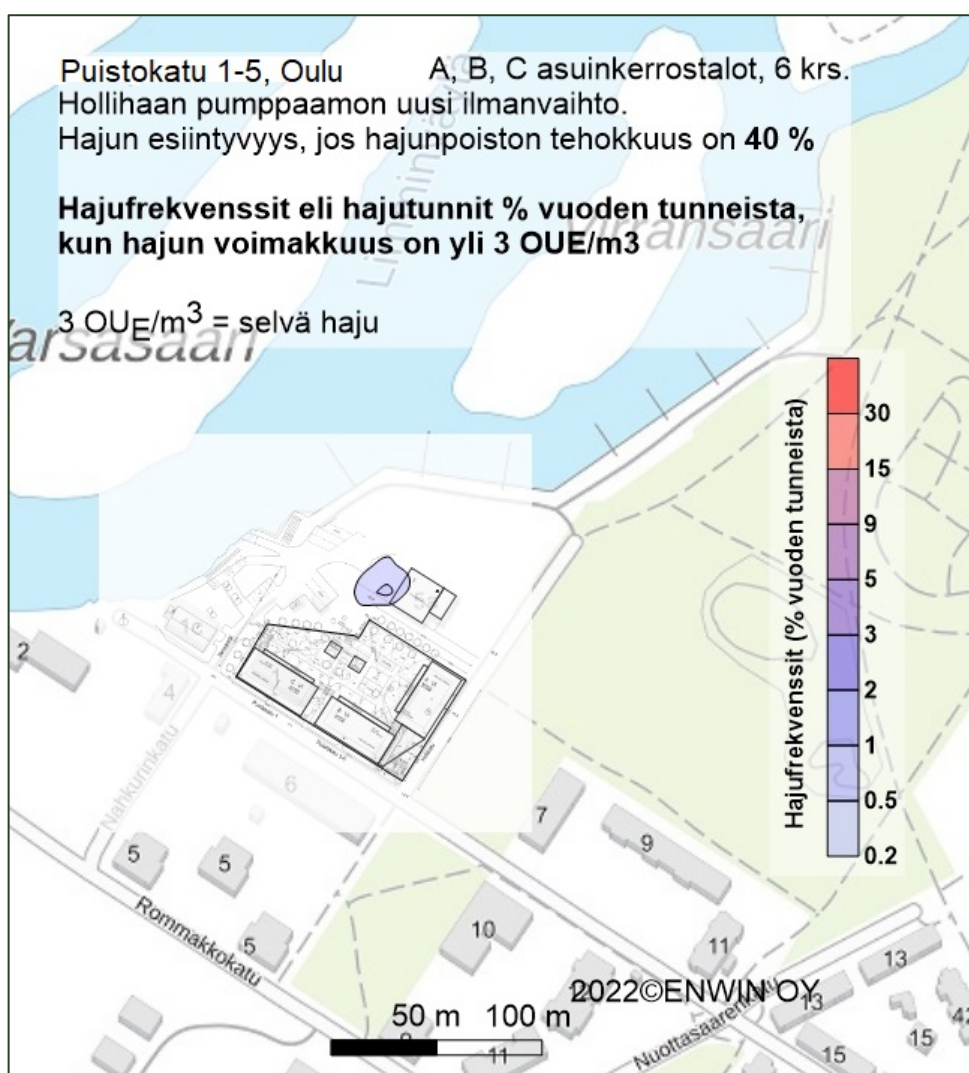
Kuva 7. Pumppaamon poistoilman aktiivihilisuodattimen hajun reduktioaste 40 %. Hajutunnit prosentteina vuoden tunneista (%) pumppaamon ympäristössä, kun hajutunnin kynnyksarvo on 3 \text{ OUE}/\text{m}^3 (= selvä, tunnistettava haju).
