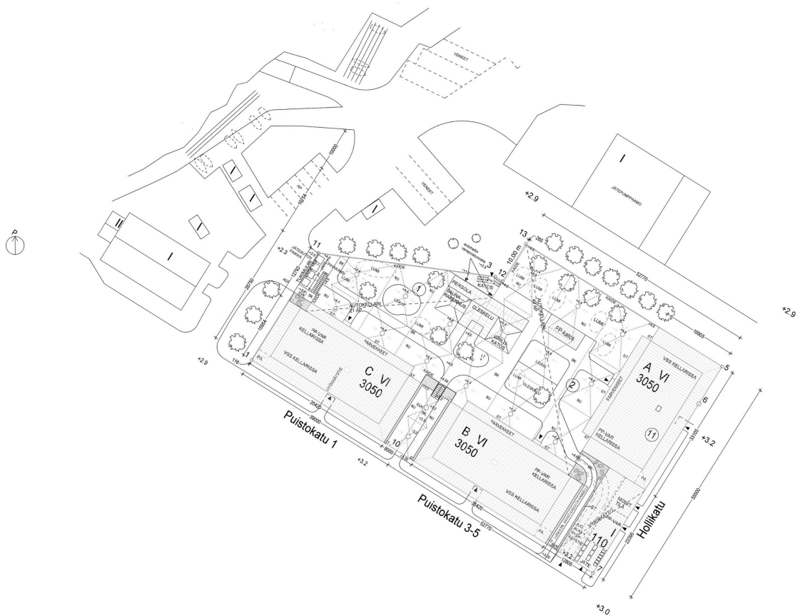
Kuva 2. Puistokatu 1-5 tonteille suunnitellut VI-kerroksiset asuinkerrostalot. Hollihaan jätevesipumppaamo sijaitsee alueen pohjois/koillispuolella.
