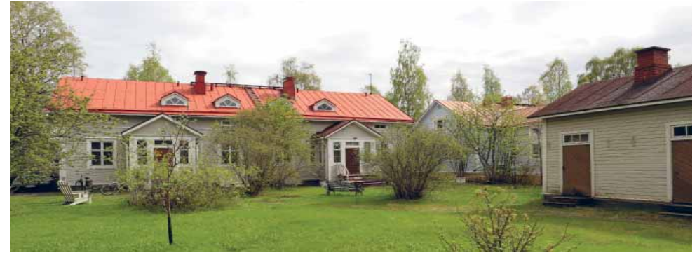
172. Tyypillinen esimerkki lähes alkuperäisenä säilyneestä päärakennuksesta ja oletettavasti alkuperäisenä säilyneestä piharakennuksesta. Päärakennuksen katujulkisivussa ei muutoksia. Alkuperäiset ikkunat ja tyylin mukaisesti uusitut kokopuiset peiliovet. Kuisteissa ja julkisivuissa ei muutoksia verrattuna rakennuslupapiirustuksiin. Vesikatto todennäköisesti alkuperäinen. Ainoat näkyvät muutokset pihan puolen kattolyhdyt. Piharakennuksessa ei havaittuja muutoksia. (Kuva: Riitta Kosonen, Arkkitehtitoimisto Jorma Teppo Oy, 18.5.2021)
