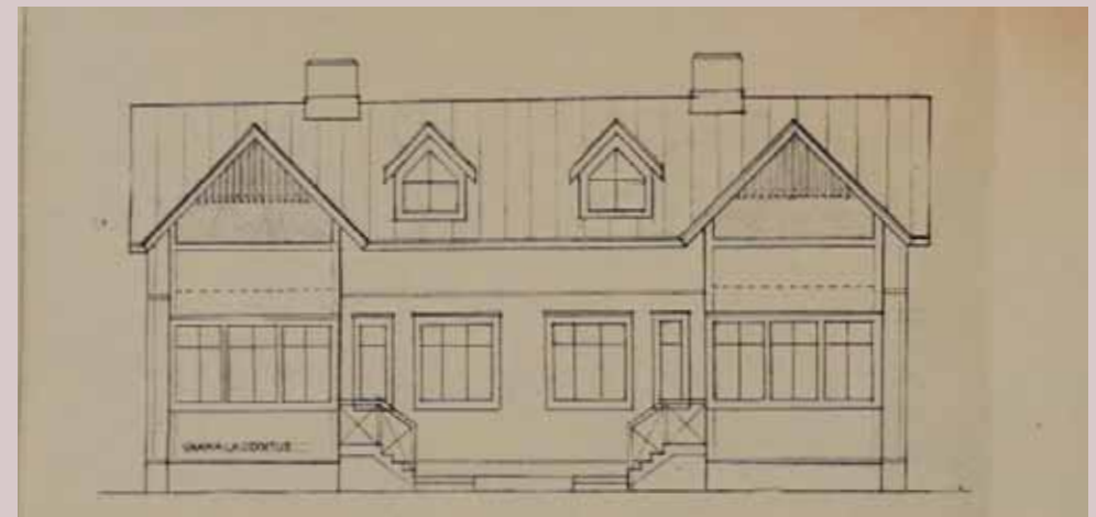
157. Esimerkki verrattain tyypillisestä 1980-luvun muutoksesta. Asuinrakennus on muutettu paritaloksi. Kuisteja on korotettu ja niiden yläosaan on tehty parvekkeet. Ullakko on muutettu lämpimiksi asuintiloiksi ja ullakon keskiosiin on saatu valoa pihan puolen kattolyhtyjen kautta. Sisäänkäynnit on uudistettu ja kuisteihin on lisätty ikkunoita. Usein ikkunat vaihdettiin. Tässä uudet ikkunat ovat vanhoja muualta siirrettyjä. (Piirustus: Oulun kaupunginarkisto.)
