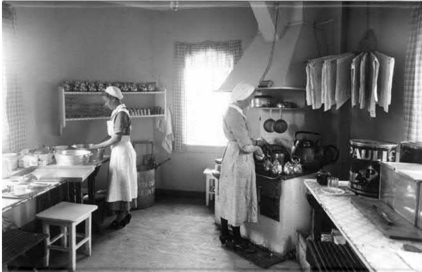
Kuva 38. Lottakahvilan keittiö. Lattiassa ”graniittimatto”, seinissä maalattu pinko-pahvi. Tilat ovat valoisat ja käytännölliset. Pohjois-Pohjanmaan museo.
