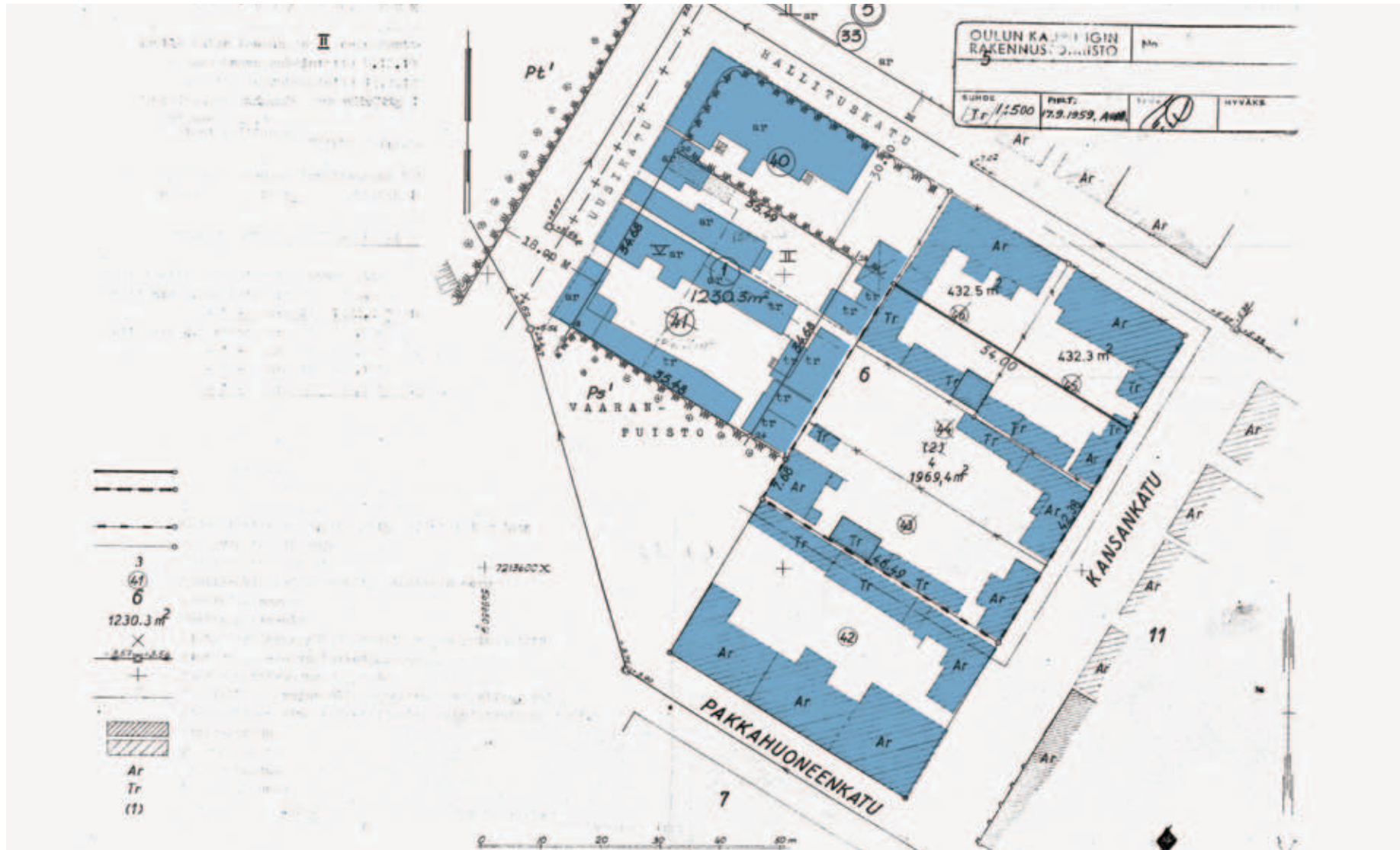
Kuva 24. Korttelin nro 6 rakennukset ja tonttijako Meurman-Ervin laatiman kaavan jälkeen 1950-luvulla: Kaavan mukaan Uuttakatu levennetään 18 metriin ja Hallituskatua puistoahöyhykkeineen peräti 30 metriin saakka. Tontilla nro 40 sijaitseva Oulun Suomalaisen klubin rakennus jää kokonaan katu- ja puistoalueille.
