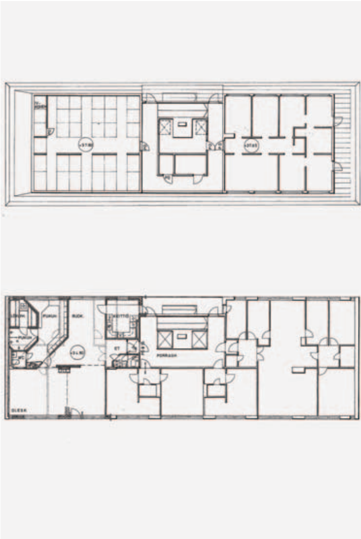
Kuva 61. Arkkitehtitoimisto Harju & Co:n vuonna 1987 laatimat muutossuunnitelmat Postipankin sauna- ja edustustiloille Klubitalon 10. kerrokseen. Ilmanvaihto-konehuone sijoitettiin ullakkokerrokseen (ei mittakaavassa).
