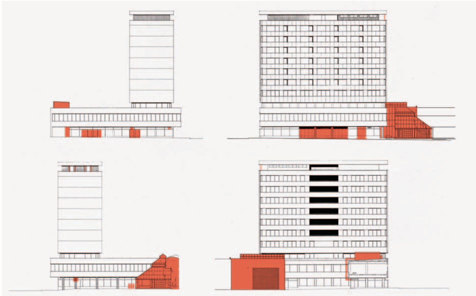
Kuva 82. Julkisivujen säilyneisyyskaaviot. Muutosalueet on esitetty kuvassa väritettynä.
