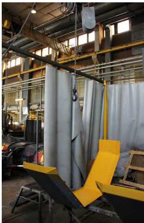
145. Maalausnurkkaus on erotettu hitsausverholla.
